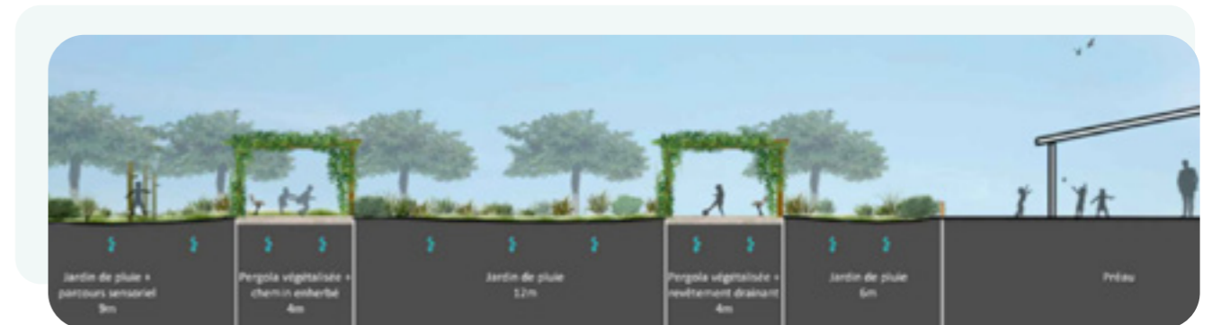
Coupe schématique des aménagements – École Henri de Bornier à Lunel (©Cereg)
