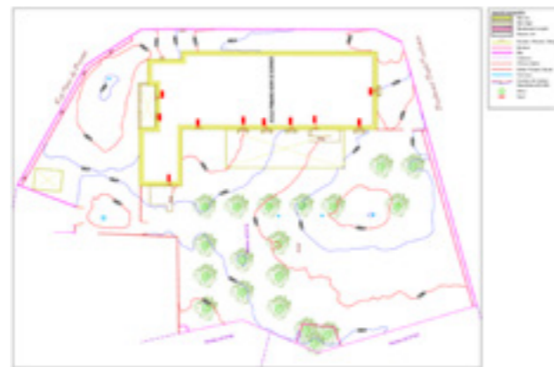
État des lieux de la topographie et des revêtements de sol – École Henri de Bornier à Lunel (©Cereg)
