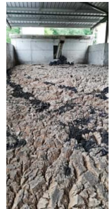
Stockage de boues chaulées
